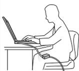
交流电源适配器与电源插座和计算机连接后会发热。使用适配器时请勿将其与身体的任何部位接触。切勿使用交流电源适配器取暖。长时间与身体接触，即使隔着衣服，仍可能灼伤皮肤。
