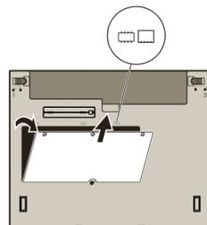
7 Se um módulo SO-DIMM já estiver instalado, remova-o conforme indicado. Salve o módulo SO-DIMM para utilização futura.
