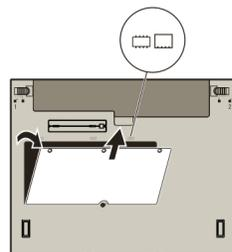
7 Ako je SO-DIMM već instaliran, uklonite ga kako je pokazano. Spremite SO-DIMM za buduću upotrebu.
