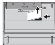
7 Wenn bereits ein SO-DIMM installiert ist, entfernen Sie es wie dargestellt. Bewahren Sie das SO-DIMM sorgfältig auf.
