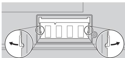
8 Richten Sie die Kerbe an der Kontaktseite des SO-DIMMs an der Spitze im Steckplatz aus. Drücken Sie das SO-DIMM in einem Winkel von 20 Grad fest in den Steckplatz. Drehen Sie es nach unten, bis es hörbar einrastet.
