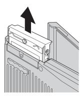
6. Lösen Sie die Abdeckung vom Festplattenlaufwerk.
