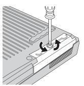
5. Öffnen Sie den LCD-Bildschirm. Stellen Sie den Computer hochkant auf und entfernen Sie das Festplattenlaufwerk, indem Sie die Abdeckung vom Computer abnehmen.
