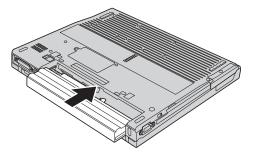
5. Schieben Sie Akkuverriegelung in die Position "Verriegelt".
