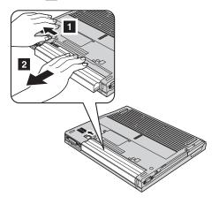
4. Installieren Sie einen vollständig geladenen Akku im Computer.
