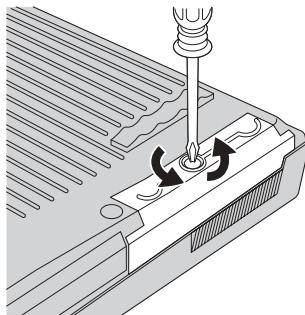
5. 打开计算机显示屏；然后使计算机侧立，从计算机拉出外盖以卸下硬盘驱动器。
