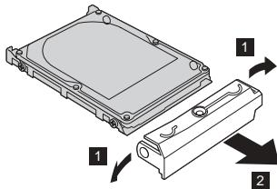
7. 将外盖连接到新的硬盘驱动器上。
