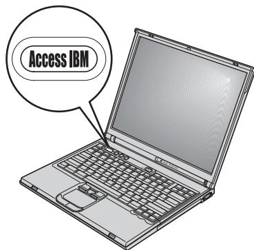
蓝色的 Access IBM 按键在计算机工作正常时可以在很多情况下帮助您，甚至在计算机工作不正常时也能帮助您。在您的桌面上，按 Access IBM 按键来打开 Access IBM。Access IBM 是板载计算机帮助中心，提供信息丰富的图解和易于遵循的指导，从而助您入门和保持高效工作。您也可以使用 Access IBM 按键来中断您计算机的启动顺序并启动 IBM Rescue and Recovery<sup>™</sup>。如果 Windows 没有正确启动，则在您的计算机的启动顺序期间按 Access IBM 按键并启动 IBM Rescue and Recovery。使用该区域来运行诊断、复原备份（假设您已经使用 IBM Rescue and Recovery 做了备份）、恢复出厂内容（也就是在您收到计算机时计算机上的内容）、启动使您能够更改启动顺序的实用程序、获取基本的系统信息及启动用来检查和更改 BIOS 设置的 IBM BIOS Setup Utility。
