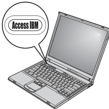
當電腦運作正常時，藍色的 Access IBM 按鈕可協助您處理許多情況，甚至電腦運作不正常時，該按鈕一樣可提供協助。請在您的桌面上，按下 Access IBM 按鈕來開啓 Access IBM。Access IBM 是內建的電腦說明中心，可提供參考圖例和簡易的指示，讓您盡快上手及維持生產力。您也可使用 Access IBM 按鈕中斷電腦開機程序，來啓動 IBM Rescue and Recovery™。如果 Windows 無法正確啓動，請在電腦進行開機程序期間按下 Access IBM 按鈕，來啓動 IBM Rescue and Recovery。您可以使用此區域來執行診斷、還原備份（假設您已經使用 IBM Rapid Restore™ Ultra 建立備份）、還原成出廠內容（亦即您收到電腦時，其中電腦所附的內容）、啓動可供您變更啓動順序的公用程式、取得重要的系統資訊，以及啓動 IBM BIOS Setup Utility 來檢查和變更 BIOS 設定。
