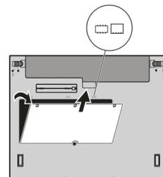
Se um módulo SO-DIMM já estiver instalado, remova-o conforme indicado. Separe o módulo SO-DIMM para utilização futura.
