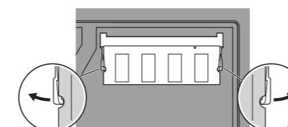
8 Совместите выемку на ребре модуля с выступом в гнезде. С небольшим усилием вставьте модуль в гнездо под углом 20 градусов 1, а затем приподнимите его вниз, пока он не защёлкнется в положении 2.
