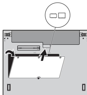
7 Если SO-DIMM уже установлен, снимите его (см. рисунок) и сохраните на будущее.
