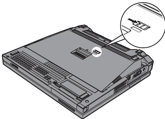
5. バッテリーが持ち上がるまでイジェクト・ラッチを押して **1**、バッテリーを取り外します **2**。
