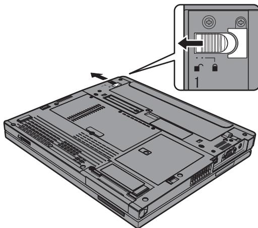
4. バッテリー・ラッチをアンロック位置にスライドさせて押さえながら **1**、バッテリーを取り外します **2**。
