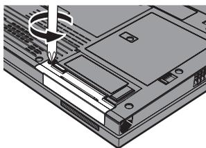
6. 液晶ディスプレイを開きます。ThinkPad を横に倒し、ThinkPad からカバーを引き出して、ハードディスク・ドライブを取り外します。
