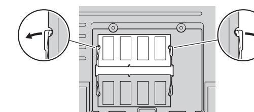
8 Poravnajte urez na kontaktnom rubu SO-DIMM-a s razdjelnikom na utičnicu. Čvrsto umetnite SO-DIMM u utičnicu pod kutom od 20 stupnjeva i tada ga usmjerite prema dolje dok ne klikne 1 na svom mjestu 2.
