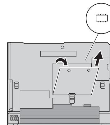
7 Ako je SO-DIMM već instaliran, uklonite ga kako je pokazano. Spremite SO-DIMM za buduću upotrebu.
