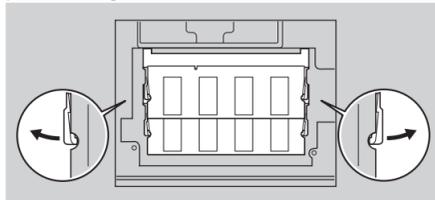
**9** Alignez l'encoche sur le bord de la barrette de mémoire SO-DIMM avec le diviseur du connecteur. Appuyez fermement pour insérer la barrette SO-DIMM dans le port avec un angle de 20 degrés **1**, puis faites-la pivoter vers le bas jusqu'à ce qu'elle soit en place **2**.
