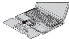
**8** Se un modulo SO-DIMM è già installato, rimuoverlo come riportato. Conservare il modulo SO-DIMM per un uso futuro.
