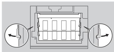
**9** Allineare il bordo del modulo SO-DIMM al divisore nel socket. Inserire fermamente il modulo SO-DIMM nel socket a un angolo di 20 gradi **1**, quindi ruotarlo fino a che si blocca al suo posto **2**.
