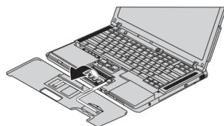
**8** Si ya existe un SO-DIMM instalado, extráigalo como se indica. Guarde el SO-DIMM para usos futuros.
