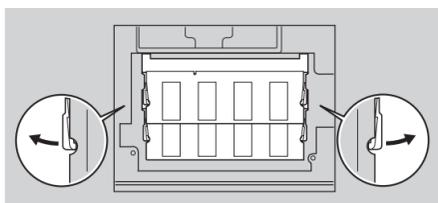
**9** Alinee la muesca del extremo con contactos del SO-DIMM con el divisor de la ranura. Inserte firmemente el SO-DIMM en la ranura con un ángulo de 20 grados **1** y desplácelo hacia abajo hasta que encaje con un chasquido **2**.
