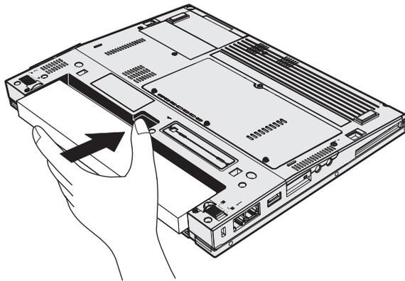
6. Fare scorrere il blocco della batteria in posizione di blocco.
