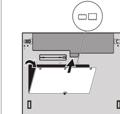
7 Ako je SO-DIMM već instaliran, uklonite ga kako je pokazano. Spremite SO-DIMM za buduću upotrebu.
