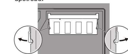
8 Poravnajte urez na kontaktnom rubu SO-DIMM s razdjelnikom u utičnicu. Čvrsto umetnite SO-DIMM u utičnicu pod kutom od 20 stupnjeva 1, zatim usmjerite i tada ga gurnite prema dolje dok ne sjedne na mjesto 2.
