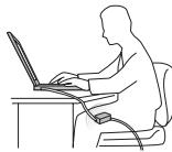
Strujni ispravljač stvara toplotu kada je priključen u utičnicu i u računar. Nemojte dodirivati strujni ispravljač ni jednim delom tela dok je u upotrebi. Nikada nemojte koristiti ispravljač da zagrejete telo. Dug period dodira sa vašim telom, čak i kroz odeću, može izazvati opekomine.
