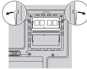
7. Com a extremidade ranhurada da SO-DIMM em direção à lateral da borda de contato do soquete, insira a SO-DIMM firmemente no soquete em um ângulo de aproximadamente 20 graus; em seguida, gire-a para baixo até que ela encaixe no lugar
