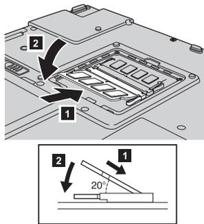
8. Reinstale a tampa do slot de memória alinhando primeiro o lado frontal da tampa e apertando os parafusos.
