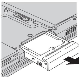
6. Insira firmemente uma nova unidade de disco rígido no compartimento; em seguida, aperte o parafuso.
