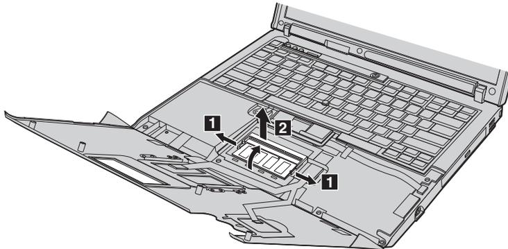
9. Con el extremo con muescas del SO-DIMM hacia el lado del borde con contactos del zócalo, inserte firmemente el SO-DIMM en el zócalo con un ángulo aproximado de 20 grados **1**; a continuación, bájelo hasta que quede fijo y encaje en su lugar **2**.
