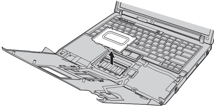
8. Si ya hay dos SO-DIMM instalados en la ranura de memoria, extraiga uno de ellos para poder alojar el nuevo presionando simultáneamente hacia afuera los pestillos de ambos bordes del zócalo **1**. Asegúrese de guardarlo para poder utilizarlo más adelante **2**.
