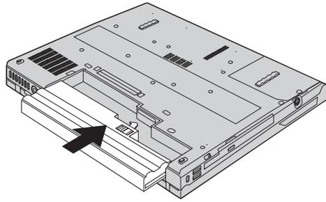
5. Deslice el pestillo de la batería a la posición de bloqueo.
