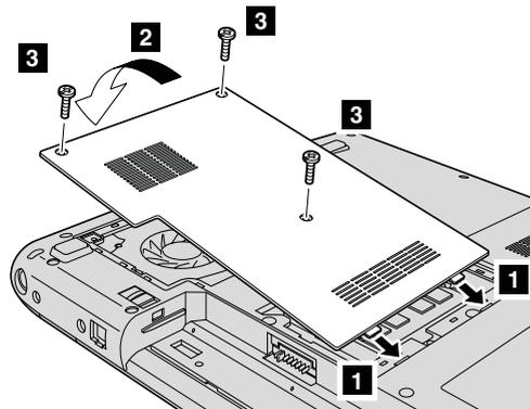
**Achtung:** Stellen Sie sicher, nachdem Sie ein SO-DIMM hinzugefügt oder aufgerüstet haben, dass die Abdeckung des Speichersteckplatzes geschlossen ist, bevor Sie Ihren Computer wieder verwenden. Benutzen Sie den Computer niemals mit geöffneter Abdeckung.
