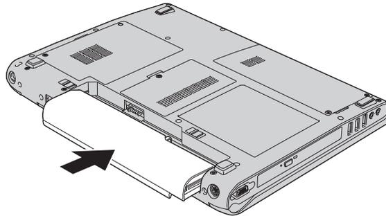
6. Stellen Sie sicher, dass sich die Akkuverriegelung in der Position "Gesperrt" befindet.
