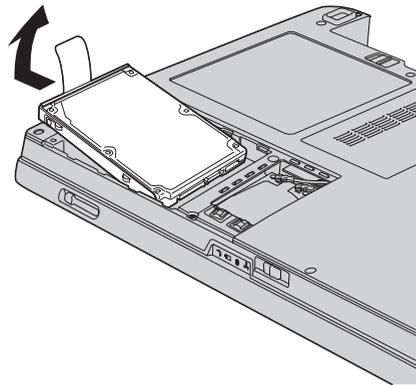
6. Setzen Sie ein neues Festplattenlaufwerk in die Festplattenlaufwerkposition ein, und schieben Sie es fest in die Position, um die Verbindungen herzustellen.
