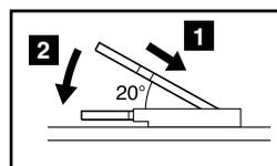
9. Drücken Sie das SO-DIMM in den Steckplatz, bis es hörbar einrastet.
