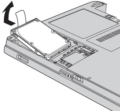
6. 將新的硬碟置入硬碟機機槽並穩固地連接。
