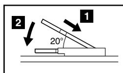
9. 將 SO-DIMM 往下壓直到卡合定位。
