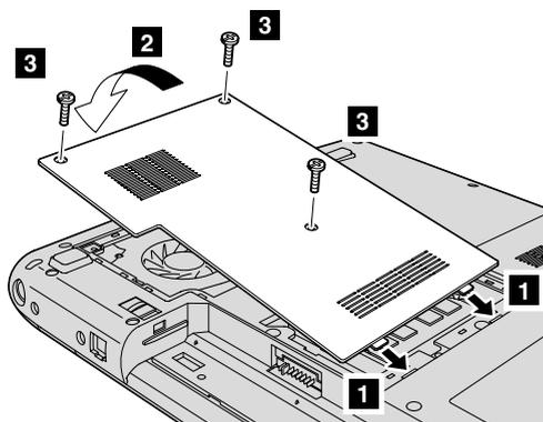
**警告：** 新增或升級 SO-DIMM 後，請將記憶體插槽外殼蓋好後，再使用電腦。千萬不要在外殼打開的情況下使用電腦。
