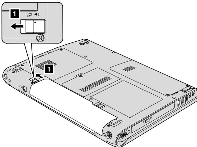
4. 將電池卡榫 **2** 推至解除鎖定位置並固定於該位置，然後移除電池。 **3**
