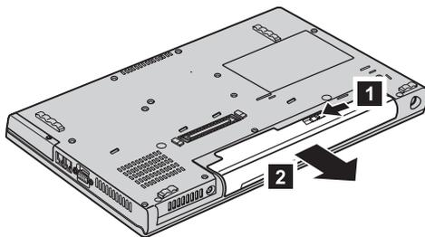
4. Instale una batería completamente cargada.
