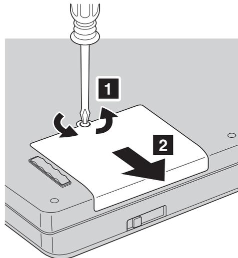
Levante la cubierta de la unidad de disco duro y extráigala.
