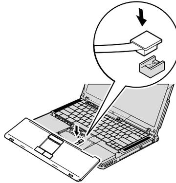
11. Alinee el lateral frontal del reposa manos con el borde frontal del sistema **1** y, a continuación, baje el reposa manos para sustituirlo **2**.
