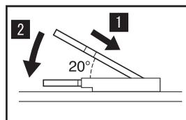
10. Conecte firmemente el conector del cable del reposa manos a la placa del sistema.
