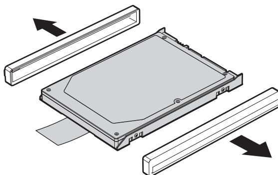
7. 將邊緣橡皮軌裝到新的硬碟機上。
