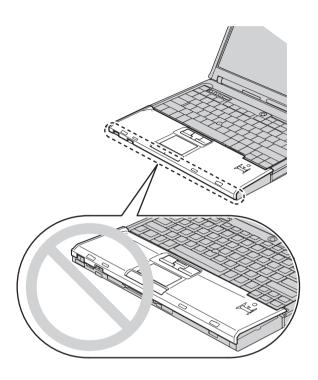
c. パームレストをキーボードの方に少し押し 1、次にパームレストの左上 2 と右上 3 の端を押して、所定の位置に収めます。
