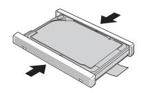
8. ハードディスク・ドライブ・ベイにハードディスク・ドライブを挿入し、しっかり と取り付けます。
