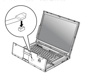
b. パームレストの左右の上端を押し、所定の位置に収めます。
