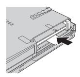
9. ベイのカバーを元の位置に取り付けてから 11、ねじを元の位置に取り付けます 2 。
