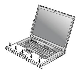
d. 液晶ディスプレイを閉じ、ThinkPad を裏返します。パームレストの 4 つのねじ を取り付け直します。
