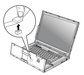
6. メモリー・スロットにすでに 2 つの SO-DIMM が取り付けられている場合は、いずれか 1 つを取り外して、新しいモジュール用に場所を空けます。ソケットの両端にあるラッチを同時に外側に押します。古い SO-DIMM は大切に保管しておいてください。
