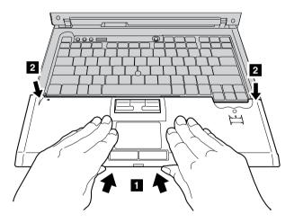
b. 下の図に示すようにパームレストの左上の端を押して、所定の位置にはめ込みま す。パームレストの左上の端、右上の端、および前側がしっかりと取り付けられ ていることを 確認します。
