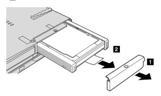
6. ハードディスク・ドライブからサイド・ラバー・レールを取り外します。
