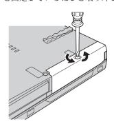
5. カバーを取り外します 1. 次にタブを引き出して、ハードディスク・ドライブを 取り外します 2。
