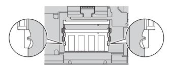
7. SO-DIMM のノッチがソケットの接触エッジ側になるようにして、SO-DIMM を約 20 度の角度でしっかりとソケットに差し込みます **1** 。次に、カチッと音がして正しい位置に収まるまで下方向に倒します **2** 。
