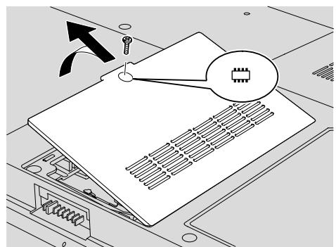
6. 若記憶體插槽中已安裝兩個 SO-DIMM，請同時按下插槽兩側的卡榫，移除其中一個，以挪出空間安裝新的 SO-DIMM。請確定留存所移除的 SO-DIMM 以供未來使用。
