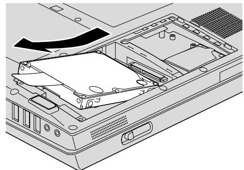
6. 將新硬碟置入硬碟槽並妥善連接。
