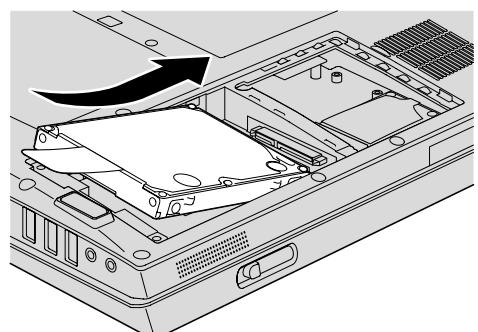
7. 對齊硬碟外殼前緣，重新安裝外殼，然後鎖緊螺絲。
