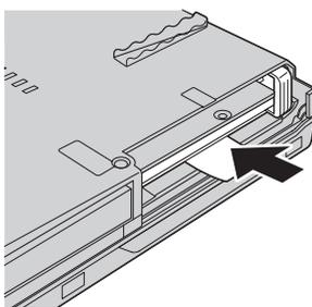
10. Reinstale a tampa do slot da unidade de disco rígido.
