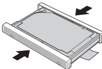
9. Insira a unidade de disco rígido no compartimento da unidade de disco rígido; em seguida, pressione-a firmemente até o encaixe.
