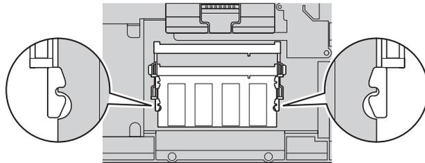
7. Com a extremidade ranhurada da SO-DIMM voltada para a lateral da borda de contato do soquete, insira a SO-DIMM firmemente no soquete em um ângulo de aproximadamente 20 graus **1**; em seguida, gire-a para baixo até o encaixe **2**.
