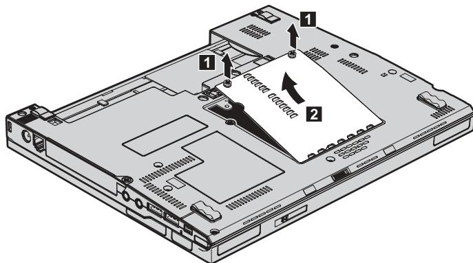
6. 메모리 슬롯에 두 개의 SO-DIMM<sup>o</sup>] 장착되어 있는 경우, 소켓 양쪽 끝 래치를 눌러 그 중 하나를 제거하여 새 메모리를 장착할 자리를 마련하십시오. 향후 사용할 수 있도록 기존의 SO-DIMM을 보관하십시오.
