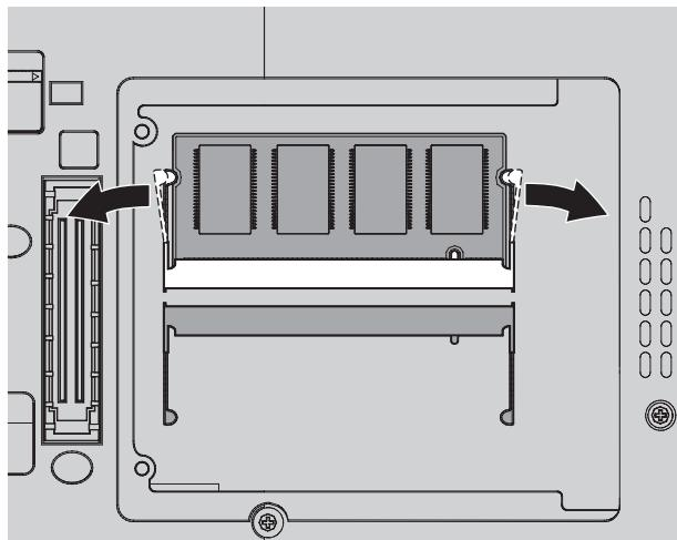
7. SO-DIMM のノッチがソケットの接触エッジ側になるようにして、SO-DIMM を約 20 度の角度でしっかりとソケットに差し込みます **1**。次に、カチッと音がして正しい位置に収まるまで下方向に倒します **2**。
