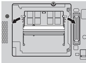
7. Приложите модуль SO-DIMM к разъему памяти (вырезом к контактам), плотно вставьте его в разъем под углом примерно 20 градусов (**1**) и поворачивайте его вверх до тех пор, пока он не встанет на место (**2**).
