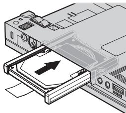
9. Вставьте **1** и поставьте на место крышку жесткого диска **2** и закрепите ее винтом **3**.
