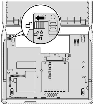
4. 將電池門鎖 **1** 推到解除鎖定的位置上，保持不動。然後取出電池 **2**。
