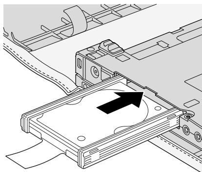
10. 重新安裝硬碟插槽外殼 **1**。然後，重新鎖上螺絲 **2**。
