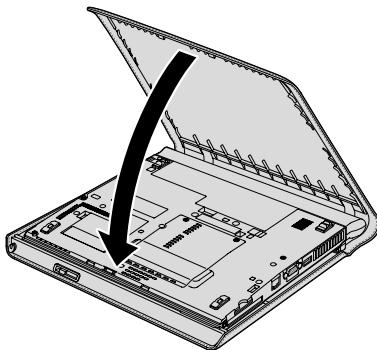
2. 依圖所示，固定住電腦的正面，將機殼往你的方向向下拉出。
