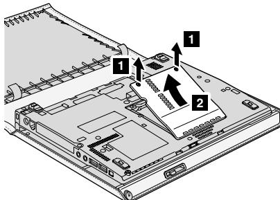
7. 若要移除已安裝的兩個 SO-DIMM 其中之一，請同時按下插槽兩側的門鎖，以騰出放置新 SO-DIMM 的空間。請務必保留舊的 SO-DIMM 供未來使用。
