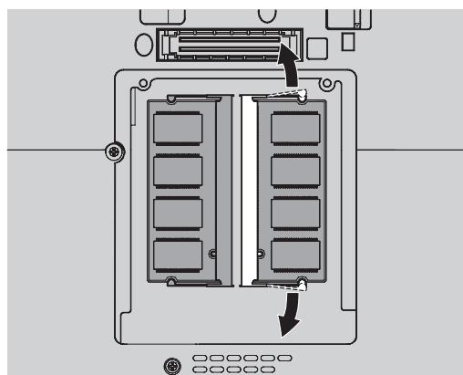
8. 將 SO-DIMM 寫入缺口朝著插槽接點側，約略以 20 度角穩固地插入插槽 **1**，然後往下壓直到卡入定位 **2**。
