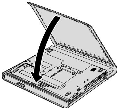
2. 如图所示，在固定住计算机前端的同时将机套向内、向下按。
