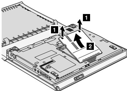
7. 将插槽两边的滑锁同时压出，卸下已安装的两条 SO-DIMM 中的一条，为新的 SO-DIMM 腾出位置。请务必妥善保存卸下的 SO-DIMM，以备将来使用。
