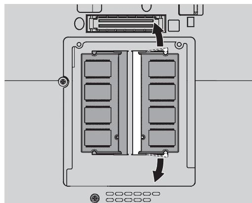
8. 将 SO-DIMM 有槽口的一端向着插槽的接触边一侧，以大约 20 度倾角将 SO-DIMM 牢固地插入插槽 **1**；然后将其向下旋入，直至咬合到位 **2**。
