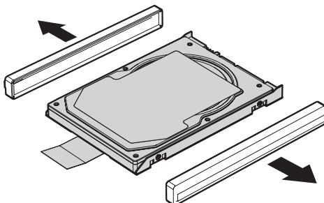
8. 将原硬盘驱动器两侧的橡胶导轨安装在新的硬盘驱动器上。
