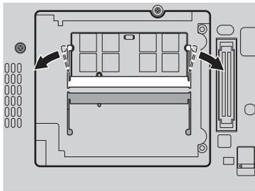
7. Sa izrekanim delom SO-DIMM modula okrenutim ka kontaktu priključka, čvrsto postavite SO-DIMM u priključak pod uglom od oko 20 stepeni **1** ; a zatim ga okrenite prema dole dok ne škljocne na svojem mestu **2** .
