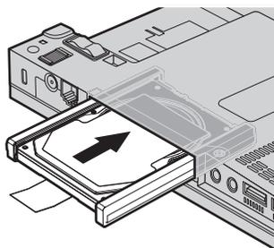
9. Vratite **1** i poklopac priključka hard diska **2**, a zatim vratite vijke **3**.
