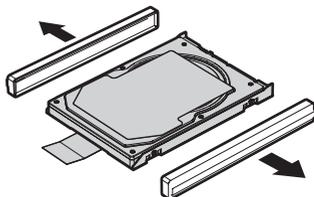
7. Stavite stranične gumene nosače na novi hard disk.
