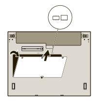
7 SO-DIMMがすでに取り付けられている場合は、 図のようにして取り外します。取り外したSO-DIMM は将来の使用に備えて保管しておいてください。
