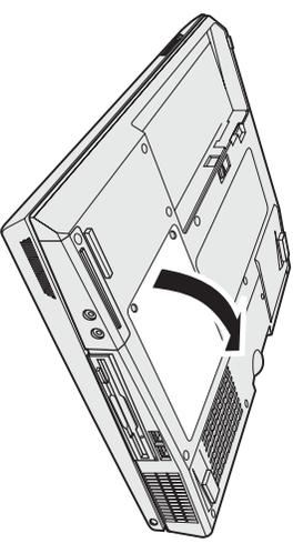
Wenn sich bereits zwei SO-DIMMs in den Hauptspeichersteckplätzen befinden, entfernen Sie ein SO-DIMM, um für das neue Platz zu machen. Drücken Sie dazu die beiden seitlichen Verriegelungen des Steckplatzes gleichzeitig nach außen. Bewahren Sie das alte SO-DIMM auf, für den Fall, dass Sie es später noch benötigen.
