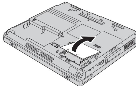
如果記憶體插槽上已經有 SO-DIMM，請同時向外按下插槽兩端的卡榫將它卸下，以便將空間讓給新的使用。請妥善保管供以後使用。
