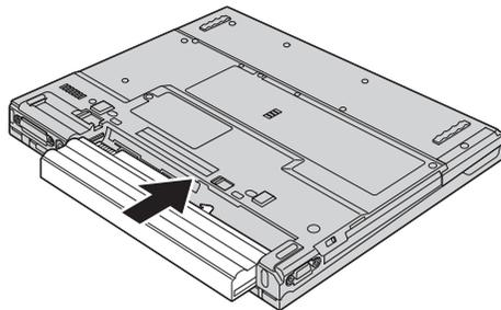
5. Desloque os fechos da bateria para as posições de bloqueio.
