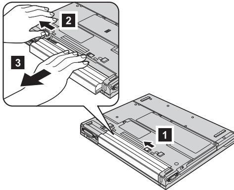
4. Instale uma bateria com a carga completa.
