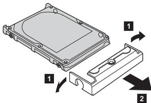
7. Encaixe a tampa na nova unidade de disco rígido.
