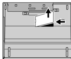
7 Ako je SO-DIMM već instaliran, uklonite ga kako je pokazano. Spremite SO-DIMM za buduću upotrebu.
