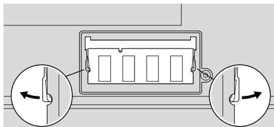
8 Poravnajte urez na kontaktnom rubu SO-DIMM-a s razdjelnikom na utičnici. Čvrsto umetnite SO-DIMM u utičnicu pod kutom od 20 stupnjeva 1 i tada ga usmjerite prema dolje dok ne klikne na svom mjestu 2
