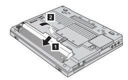
b) Schieben Sie die Akkuverriegelung nach links, um sie zu sperren.
