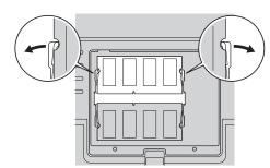
5. Stellen Sie fest, an welchem Ende des SO-DIMMs sich eine Kerbe befindet.
