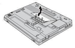
Wenn sich bereits ein SO-DIMM im Hauptspeichersteckplatz befindet, entfernen Sie dieses, um für das neue Platz zu machen. Drücken Sie dazu die beiden seitlichen Verriegelungen des Steckplatzes gleichzeitig nach außen. Bewahren Sie das alte SO-SIMM auf, für den Fall, dass Sie es später noch benötigen.
