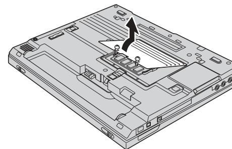
如果記憶體插槽上已經有 SO-DIMM，請同時向外按插槽兩端的卡榫將它卸下，以便將空間讓給新的使用。請妥善保管供以後使用。
