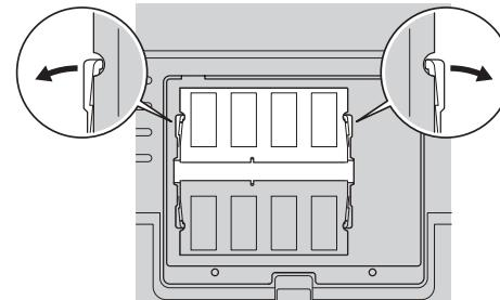
5. 找出您正在安裝的 SO-DIMM 邊上的缺口。
