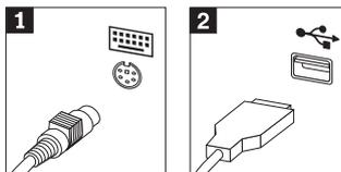
3. O computador poderá estar equipado com um cabo de rato padrão **1** ou um cabo de rato USB **2**. Ligue o cabo de rato ao conector de rato apropriado.
