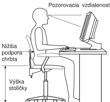
Nastavte monitor tak, aby vrchná časť obrazovky bola na úrovni očí alebo trochu pod ňou. Monitor umiestnite do pohodnej pozorovacej vzdialosti, zvyčajne 51 až 61 cm tak, aby ste naň videli bez toho, aby ste sa museli nakláňať.
