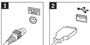
3. Vaš računalnik je morda opremljen s standardnim kablom miške **1** ali kablom miške USB **2**. Spojite kabel miške z ustreznim spojnikom miške.
