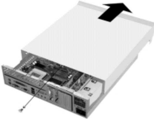
2. Mantenere le estremità del coperchio superiore dell'unità di sistema e spingerlo in avanti di circa 0,25 pollici. Sollevare il coperchio superiore per rimuoverlo completamente.
