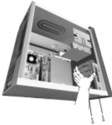
3. Tirare il vassoio di fissaggio dell'unità verso l'alto e rimuoverlo.
