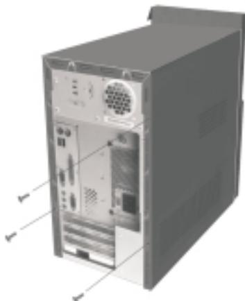
2. Mantenere le estremità del coperchio superiore dell'unità di sistema e spingerlo in avanti di circa 25 mm. Sollevare il coperchio superiore per rimuoverlo completamente.
