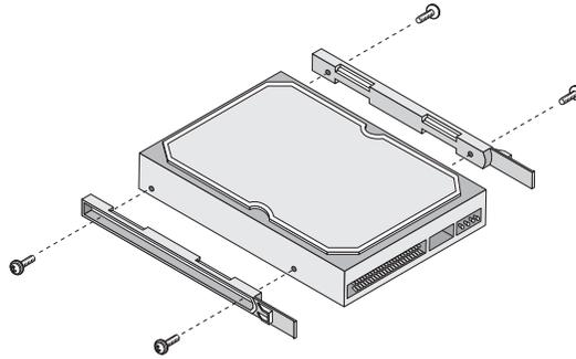
6. Monte los rieles en la unidad de disco duro que va a instalar y asegúrelos con los tornillos.
