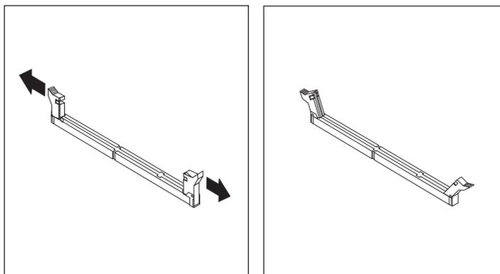
3. Sitúe el RIMM o C-RIMM sobre el conector de modo que las dos muescas del borde inferior del módulo se alineen correctamente con el conector vacío.
