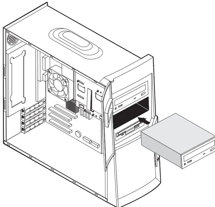
6. Si la unidad que ha instalado es una unidad de soporte de almacenamiento extraíble, coloque el marco biselado que viene con el sistema sobre la bahía de unidad.
