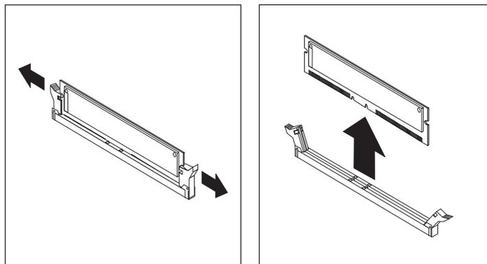
**Nota:** Tenga cuidado de no ejercer demasiada presión sobre los clips de sujeción porque el RIMM o C-RIMM podría salir despedido bruscamente.
