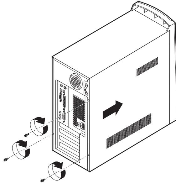
4. Asegure la cubierta con los tres tornillos.
