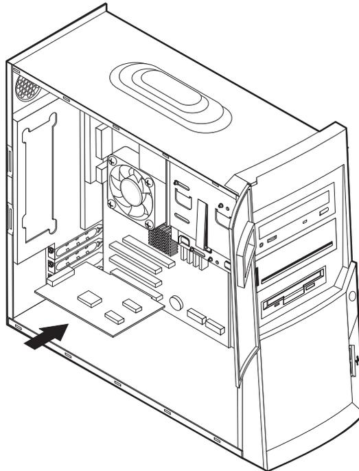
**Nota:** Si está instalando un adaptador de red soportado por Wake on LAN, conecte el cable de Wake on LAN que viene con el adaptador al conector de Wake on LAN de la placa del sistema. Consulte el apartado “Identificación de las piezas de la placa del sistema” en la página 19.
