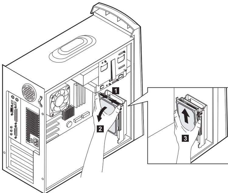
5. Retire los cuatro tornillos que aseguran los rieles a la unidad de disco duro que está desmontando.
