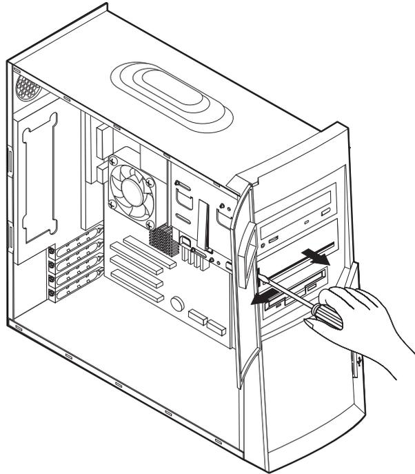
4. Retire el protector de metal EMI (interferencia electromagnética) empujándolo con cuidado desde el interior con un destornillador.
