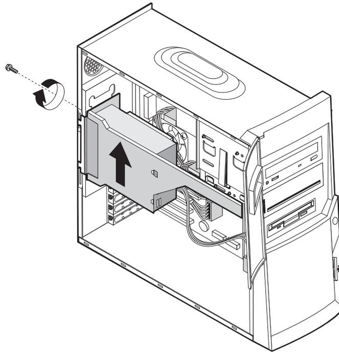
3. Gire con cuidado la fuente de alimentación hacia fuera y retire los cables de alimentación. Cuando desconecte los cables, fíjese bien dónde se conectan, de forma que los pueda volver a conectar correctamente más adelante. A continuación, retire la fuente de alimentación.
