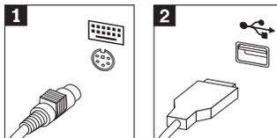
3. Кабель мыши может заканчиваться стандартным разъемом мыши ( **1** ) или разъемом USB ( **2** ). Присоедините кабель мыши к соответствующему
