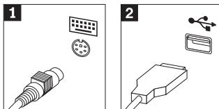
3. Váš kábel myši môže mať štandardný konektor **1** alebo USB konektor **2**. Zapojte kábel myši do príslušného konektora myši.
