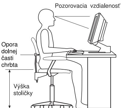
Monitor si upravte tak, aby bol vrchný okraj obrazovky na úrovni očí alebo trochu nižšie. Monitor umiestnite do pohodnej pozorovacej vzdialosti, zvyčajne 51 až 61 cm a umiestnite ho tak, aby ste naň mohli pozeráť bez otáčania tela. Aj ostatné zariadenia, ktoré pravidelne používate, ako je telefón alebo myš, umiestnite tak, aby ste ich mali ľahko dosiahnuteľné.
