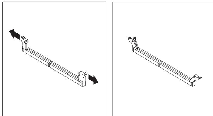
4. Vérifiez que les encoches de la barrette DIMM sont bien alignées sur les pattes du connecteur. Enfoncez la barrette DIMM dans le connecteur jusqu'à ce que les crochets de retenue se referment.
