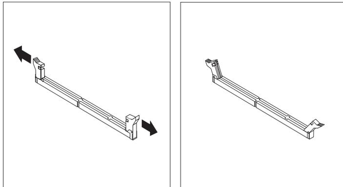
5. Vérifiez que les encoches de la barrette DIMM sont bien alignées sur les pattes du connecteur. Enfoncez la barrette DIMM dans le connecteur jusqu'à ce que les crochets de retenue se referment.
