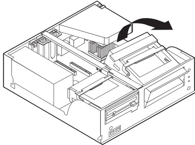
6. Installez l'unité dans la baie. Alignez les orifices et insérez les deux vis.
