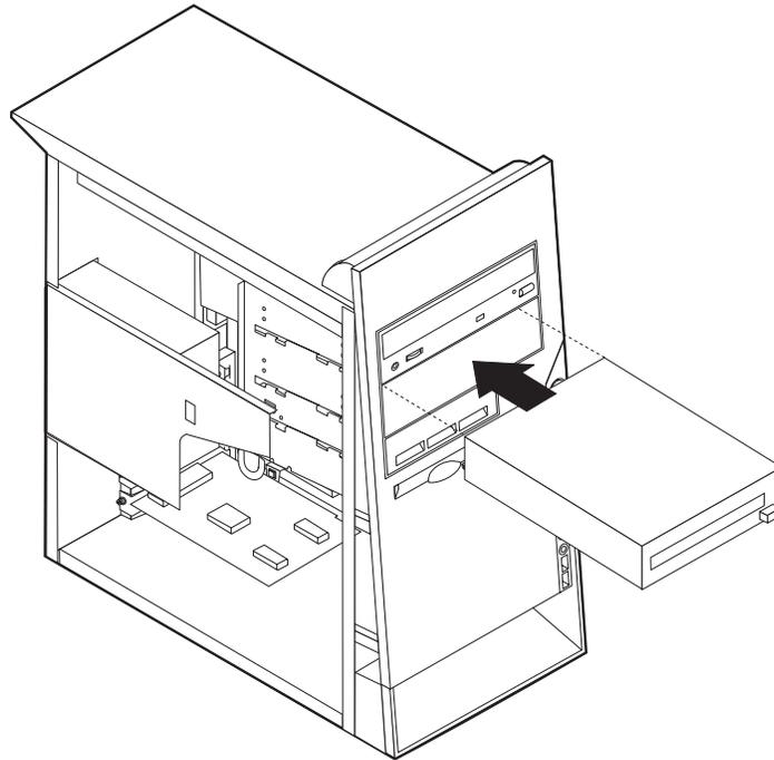
7. Chaque unité IDE est associée à deux câbles : un cordon d'alimentation à quatre fils branché sur le bloc d'alimentation et un câble d'interface relié à la carte principale. Pour une unité de CD-ROM, il se peut que vous disposiez également d'un câble audio.
