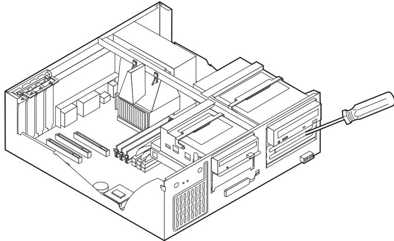
5. Faites pivoter le loquet de la baie vers la face avant de la machine, puis tirez le boîtier de l'unité vers le haut, comme indiqué, jusqu'à ce qu'il s'enclenche en position verticale.
