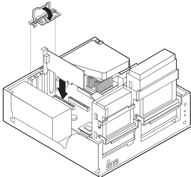
8. Remplacez la barre de support et faites à nouveau pivoter les deux baies jusqu'à leur position d'origine.
