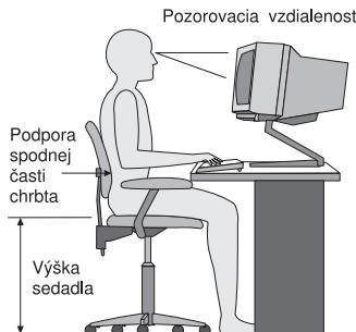
Nastavte monitor tak, aby vrch obrazovky bol na úrovni očí alebo trochu pod ňou. Monitor umiestnite do pohodnej pozorovacej vzdialenosť, zvyčajne 51 až 61 cm a dajte ho tak, aby ste naň videli bez toho, aby ste sa museli nakláňať.
