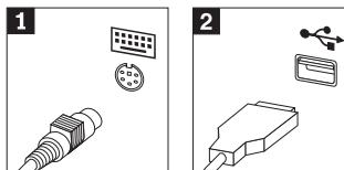
3. Kabel vašeg miša može imati standardni konektor za miša **1** ili USB konektor **2**. Spojite kabel miša na odgovarajući konektor za miša.
