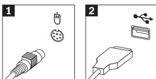
4. Si dispone del receptor inalámbrico dual de IBM, conecte el receptor a uno de los conectores USB de la parte posterior del sistema. Coloque el teclado inalámbrico IBM Rapid Access III y el ratón inalámbrico ScrollPoint en una posición que le sea cómoda.
