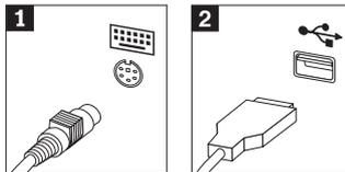
3. El cable de ratón puede tener un conector de ratón estándar **1** o un conector USB **2**. Conecte el cable de ratón al conector de ratón
